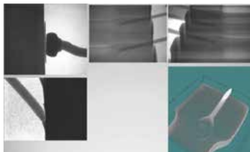
半導体 金ワイヤ \phi 20 \mu mの撮像例
